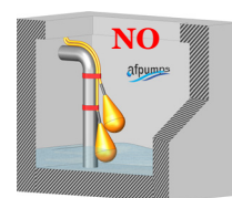
Installazione errata Wrong installation
