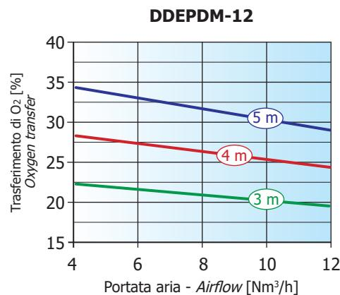
I valori di portata e pressione si intendono per il convogliamento dell'aria avente in aspirazione temperatura di 15°, densità di 1,23 kg/m<sup>3</sup> e pressione a 1.013 mbar. La tolleranza di queste curve si intende del ±10%.
