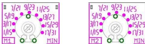
Mediante il trimmer “MIN” è possibile regolare la corrente minima del motore per la protezione contro la marcia a secco nel caso si volesse un'ulteriore protezione o non si volessero utilizzare sonde o galleggianti di minimo livello.
