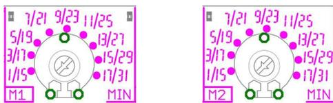
Mediante il trimmer "MIN" è possibile regolare la corrente minima del motore per la protezione contro la marcia a secco nel caso si volesse un'ulteriore protezione o non si volessero utilizzare sonde o galleggianti di minimo livello.
