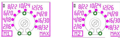
Mediante il trimmer “MAX” è possibile regolare la corrente massima del motore oltre al quale il sistema andrà in protezione per sovracorrente.
